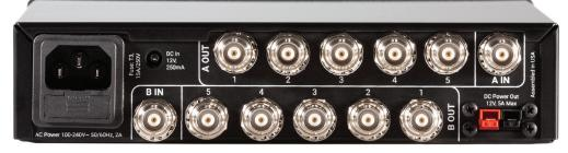
DISTRO5 HDR™は、ワイヤレスマイク用の高性能アンテナディストリビューターおよび電源分配システムです。ハーフラックサイズの筐体で、1ペアのダイバーシティアンテナを5台の受信機に分配することが可能です。
