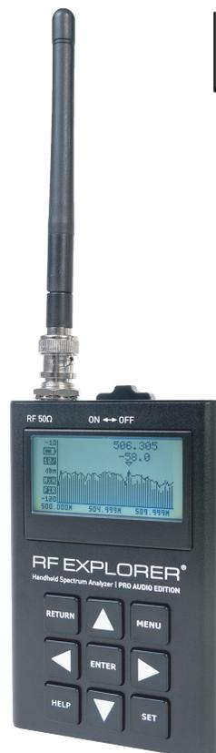
RF Explorer®Pro Audio Editionは、ワイヤレス・マイクロフォンやインイヤースピーカー・モニター・システムでの使用に特化して設計された全く新しいポータブルRFスペクトラム・アナライザーです。
