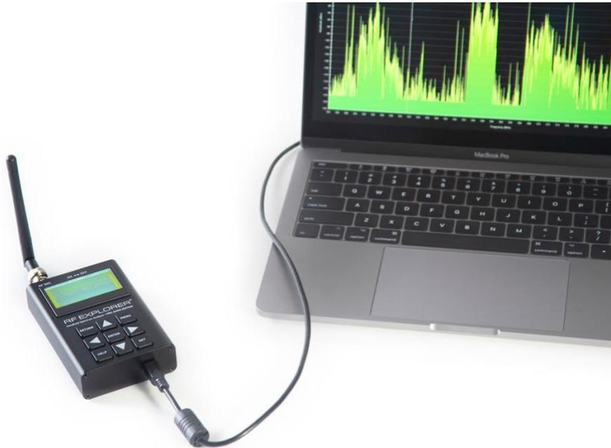
RF Explorer Pro Audio Editionは、USB経由でコンピューターに接続して、より高解像度の画面、追加機能、コントロールなどの機能を利用することができます。
