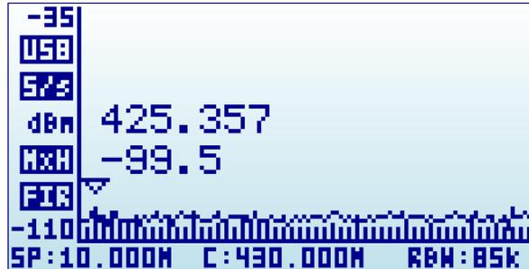
上の画面では、下段の周波数表示Start/Center/StopからSpan/Center/RBWに変更されています。このモードを有効にすると、[Left] ボタン、[Right] ボタンを押すと、それぞれ周波数スパンが2倍、1/2に増減します。
